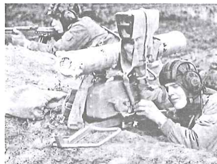
Sistema portátil del AT-4 Spigot, misil SACLOS. Nótese que dispone de una mira mucho más compleja
