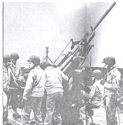
Carga a brazo de un cañón británico de 19.000 kg y calibre de 76,2 mm (3 pulgadas). Aunque anticuada, esta pieza se utilizó todavía en gran cantidad durante la primera parte de la guerra, debido a su peso reducido.
