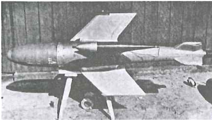
El X-4, misil Aire-Aire MLOS filo guiado. En la imagen puede apreciarse la bobina de hilo con forma de bulbo en el extremo de la aleta
