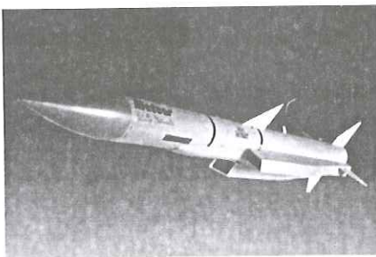
Meteor mostrando su toma de aire para el motor ramjet.
