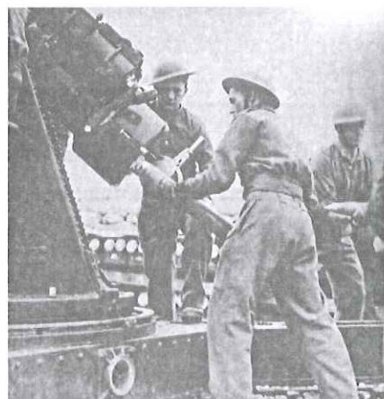
Carga a brazo de un cañón británico de 19.000 kg y calibre de 76,2 mm (3 pulgadas). Aunque anticuada, esta pieza se utilizó todavía en gran cantidad durante la primera parte de la guerra, debido a su peso reducido.
